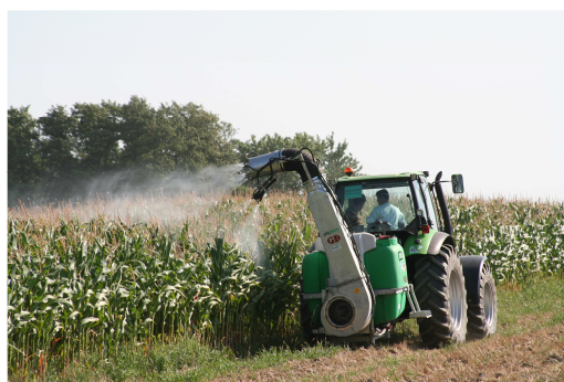
Slika 1: Škropilnica z visoko nameščenimi škropilnimi letvami in cevnimi podaljški ter pršilnik s pršilnim topom
