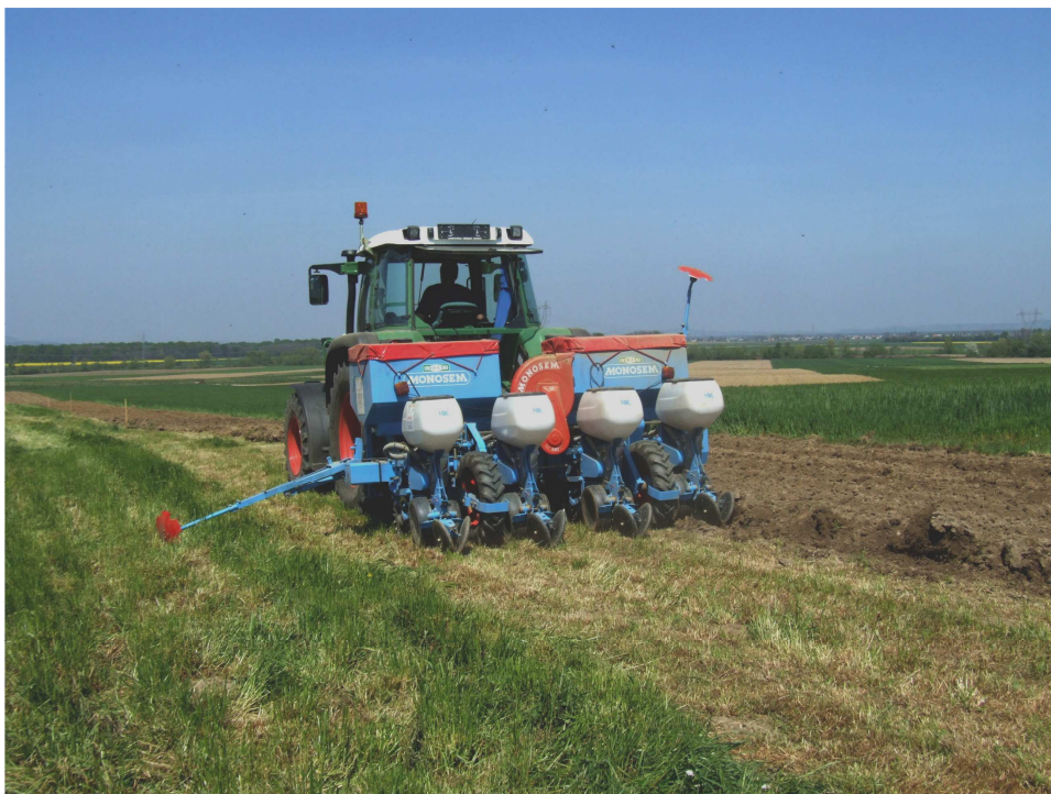
Slika 1: Direktna setev koruze s sejalnico monosem MX
