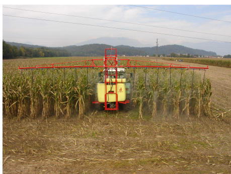
Slika 1: Škropilnica z visoko nameščenimi škropilnimi letvami in cevnimi podaljški ter pršilnik s pršilnim topom
