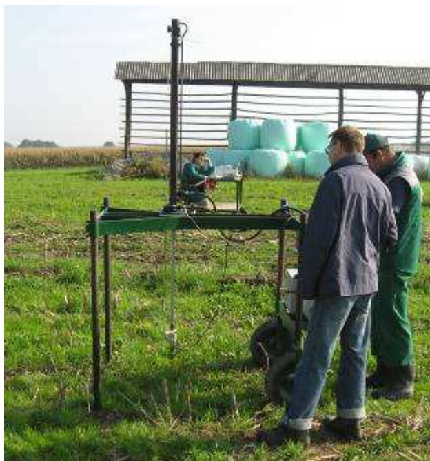
Slika 2: Merjenje zbitosti tal s penetrometrom BF
