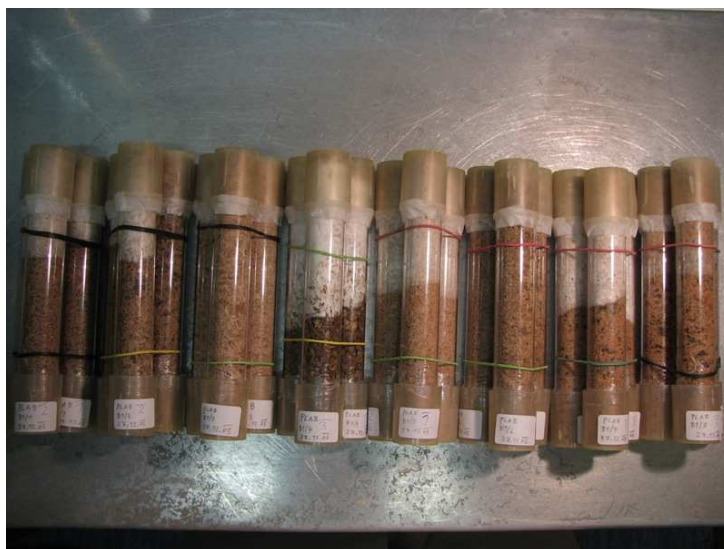
Slika 2: Podgobje P. ostreatus prerašča testne substrate
