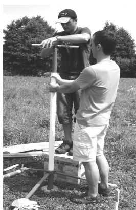
Slika 2: Vrtanje tal iz notranjosti plastične cevi
