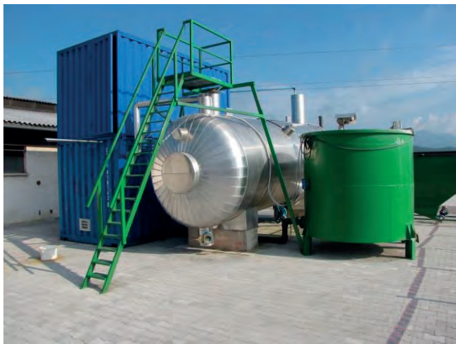
Slika 2: Mikro bioplinška naprava na Kmetijskem inštitutu Slovenije, za vhodni substrat uporabljajo gnojevko
