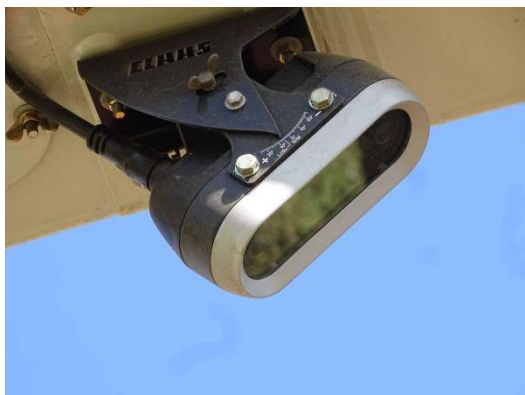
Slika 3: Stereo kamera (globinska kamera) na silažnem kombajnu Claas Jaguar 940.
