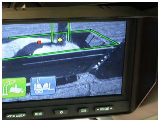
Slika 4: Prikaz delovanja Claas AUTO FILL sistema na Jaguarju 940.
