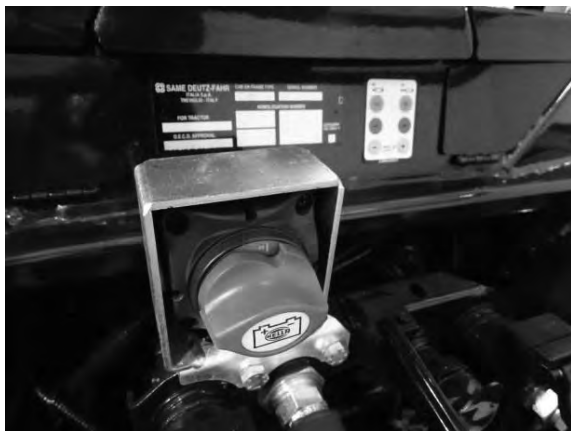
Slika 3: Na zunaj se hitro opazi stikalo za izklop elektrike (akumulatorja).
