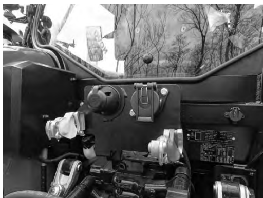
Slika 1: Na traktorju mora biti montiran dvo vodni zračni zavorni sistem
