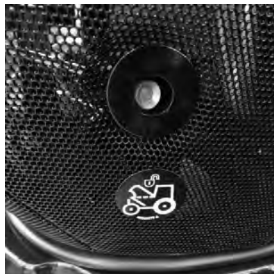
Slika 4: Ena bolj kritiziranih zahtev je bilo odpiranje pokrova motorja z orodjem.
