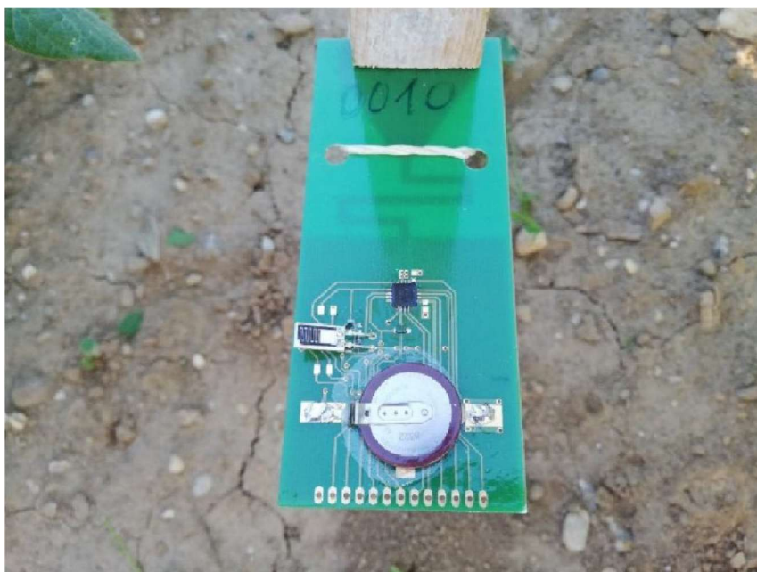
Slika 2: Pametna značka z mikročipom, senzorji, anteno in baterijo
